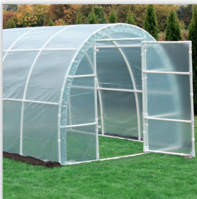
Tunele foliowe lekkie łatwe w montażu. Konstrukcja: stelaż z białych rurek PVC o średnicy 32 mm odpornych na korozję i zmianę temperatury; na stelażu napinana jest folia ogrodnicza (na 4 sezony) i przywiązana do rurek specjalnymi spinkami. Podstawą tunelu jest rama z rur PVC wzmocniona kształtkami, którą mocuje się do ziemi za pomocą szpilek metalowych. Przód i tył tunelu to prostokątne drzwi mocowane na zawiasach. Zalety: lekkość konstrukcji, łatwy i szybki montaż.
