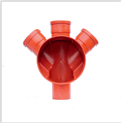
Podstawa studni (kineta). Materiał: PP o wysokiej odporności na uderzenia i zmianę temperatur, dużej trwałości i odporności chemicznej na agresywne ścieki. Średnica przelotu [mm]: 160 i 200 (kiniety przelotowe i zbiorcze z wlotami pod kątem 45° lub jednostronne, prawe/lewe – dowolne wykonywanie przyłącza – bez kolan i redukcji). Zalety: gładkie wyprofilowane dno wpływa na dobrą charakterystykę hydrauliczną, zebra usztywniające konstrukcję oraz ułatwiające posadowienie w gruncie.
