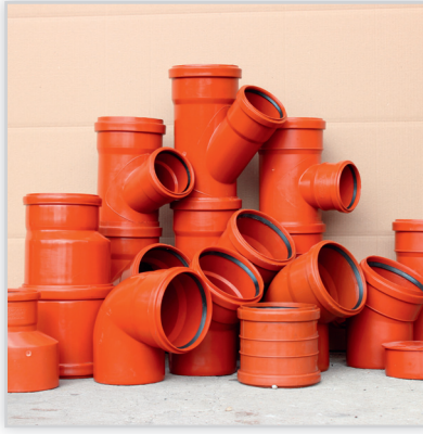
Kształtki kanalizacyjne z PVC-U. Asortyment: trójniki, kolanka, nasuwki, redukcje, korki, itp. Średnice [mm]: 200, 160, 110, 75, 50. Normy: PN-EN 1451-1.
