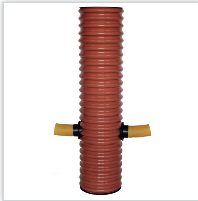
Studzienki drenarskie. Budowa: karbowane rury PCV o średnicy 315 mm + prefabrykowana pokrywa + dno wraz z uszczelkami; w rurze karbowanej wywierane są otwory, w których mocowane są uszczelki in-situ, a w nich z kolei rury drenarskie.
