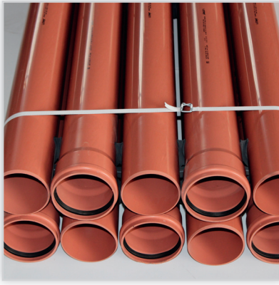
Rury kanalizacyjne z PVC-U. Zastosowanie: do budowy sieci kanalizacyjnych. Średnica [mm]: 315, 250, 200, 160, 110, 75, 50. Normy: PN-EN 1401-1:2009, PN-EN 12200-1:2002.
