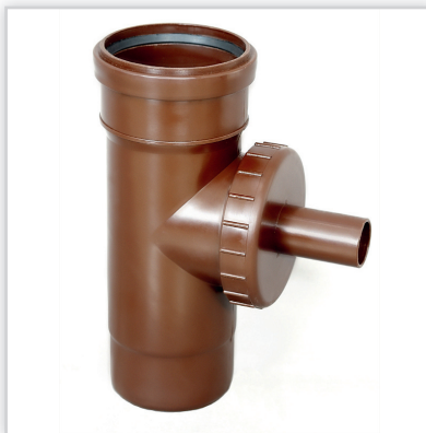
Zbieracz wody deszczowej 110 mm. Montaż: na rurze spustowej budynku na wysokości najwyższego poziomu wody w zbiorniku (nadmiar wody jest odprowadzany z posesji krótkim przelewowym do studzienek). Estetyczne wykonanie nie zaburza wyglądu systemu rynnowego. Na okres zimowy należy odkręcić nakrętkę z wylewką. Ustawienie zbiorników: w dowolnych miejscach ogrodu, w tunelu, szklarni etc. Normy: PN-EN 607:2005, PN-EN 12200-1:2002. Patent: Pat. 194609 (UPRP).
